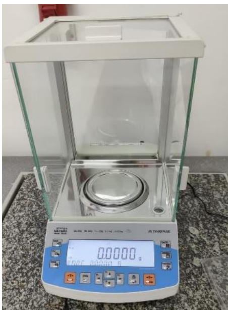
AS 310.R2 RADWAG зертханалық аналитикалық таرازы
